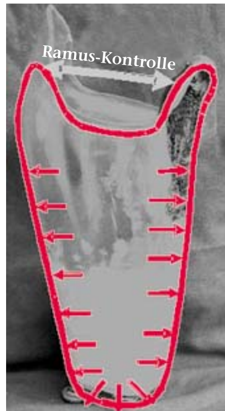
Abb. 5 Der M.A.S.-Schaft ermöglicht eine quasi-hydrostatische Kraftübertragung zwischen Stumpf und Schaft.
